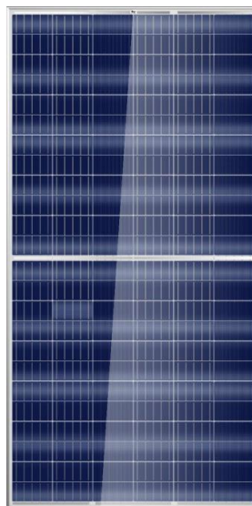
PE14H 多結晶 144 セル 出力範囲：335 - 345W モジュール寸法： 2000 × 992 × 40 mm
