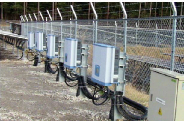
パワーコンディショナを風雨にさらし、さらに背面を南に向けて設置。過酷な条件下でのライフタイムテストです。
