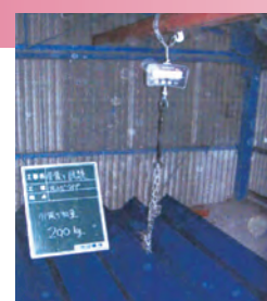
引張荷重試験状況
