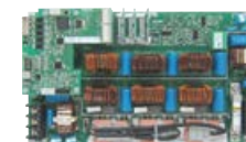
MPPT制御機能搭載 非絶縁型 電解コンデンサ&ファンレス昇圧電源
